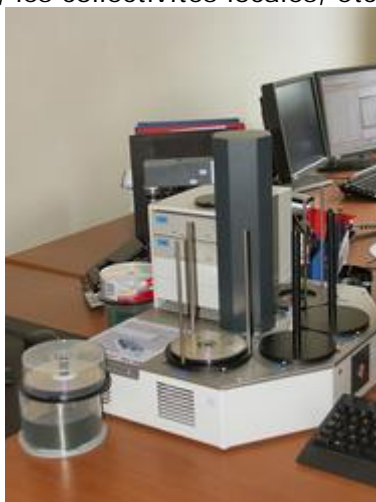
Après traitement et vérifications, les données sont gravées sur CD pour être envoyées aux bureaux fonciers. IBM prend ensuite la relève.
